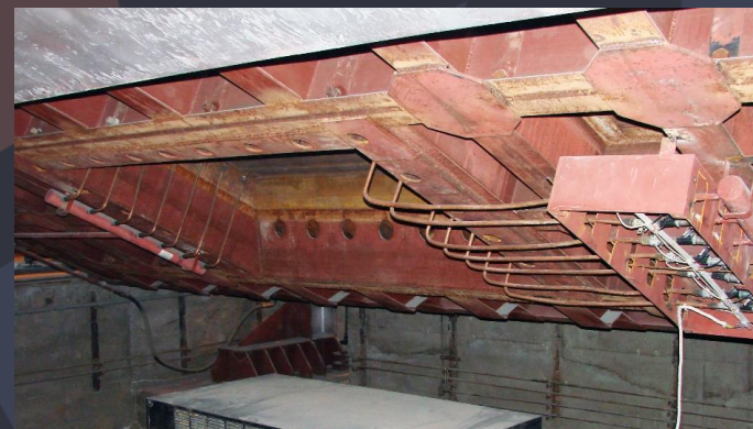
Варианты немагнитной плиты с принудительным охлаждением:
